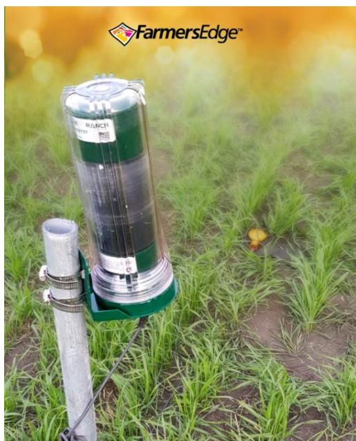
Рис. 2 Почвенный датчик влажности Farmers Edge, установленный в поле
