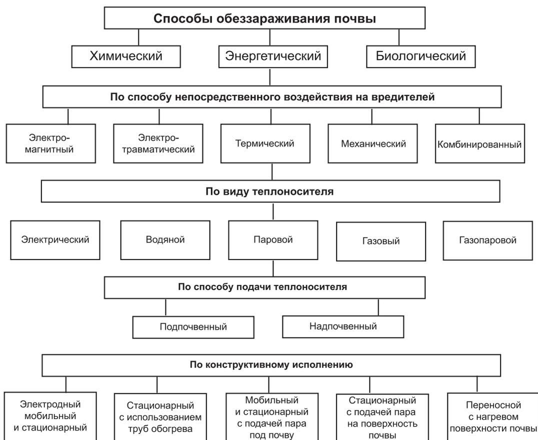
Результаты научно-исследовательских работ ВНИИО и практический опыт показывают преимущества нагрева при подаче пара непосредственно в почву. Такая подача пара обеспечивает большую равномерность температурного поля по всему объему почвы.
